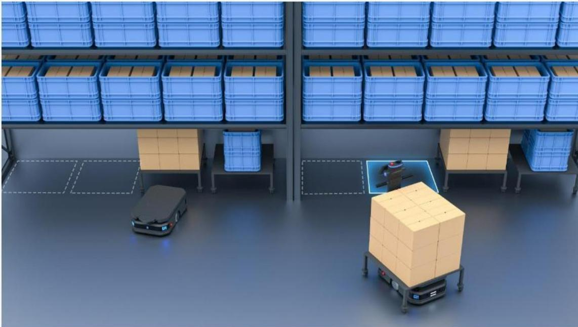
Dank fortschrittlicher Navigations- und Wahrnehmungssysteme identifiziert die T600-Serie auf intelligente Weise die Zielspeicherorte und führt selbstständig Pick-and-Place-Vorgänge durch. Dies ermöglicht vollständig unbemannte Arbeitsabläufe und gewährleistet einen effizienten und zuverlässigen Lagerbetrieb.
