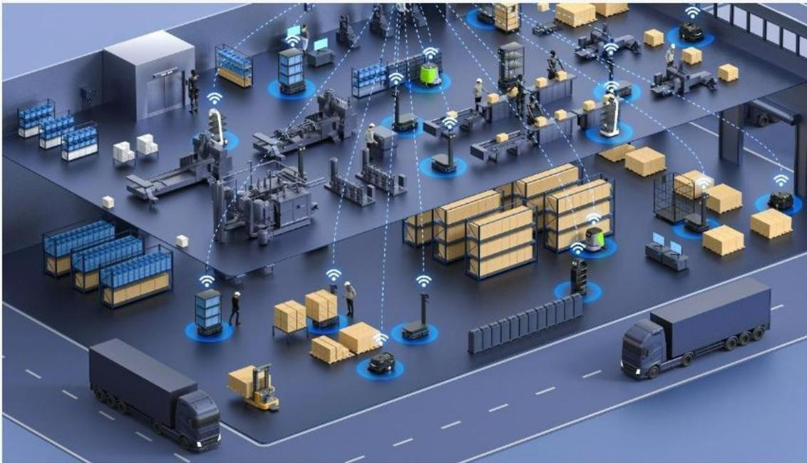
Kompatibel mit dem Kommunikationsprotokoll nach dem Standard VDA5050, was eine kollaborative Planung mit anderen kompatiblen Robotern und Systemen ermöglicht. Es sind keine kundenspezifischen Entwicklungen oder komplexen Schnittstellenintegrationen erforderlich, sodass ein einheitliches, effizientes und skalierbares flexibles Logistiknetzwerk schnell bereitgestellt werden kann.
